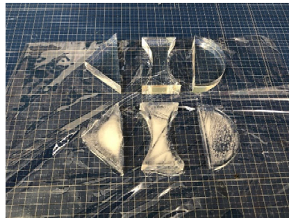
図 8 (上段) 原型の亚克力製レンズ (下段) 複製した氷レンズ
