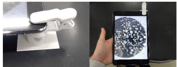
アウトカメラで観察している様子 高さ合わせのため、手で押さえたり、裏にスペーサーを入れたりして調整する
